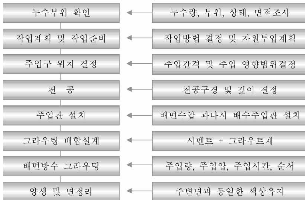
【그림 6.3.12】 배면주입방수 공법의 시공순서도
